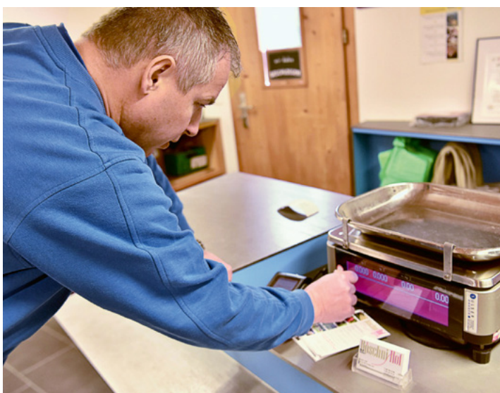
Bernhard Willi setzt die smarte Waage auf null, bevor er die Gewichtssteine auflegt.
