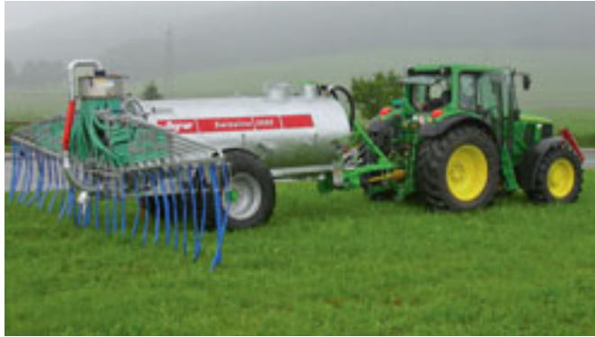
Mit dem Schleppschlauchverteiler gelangt die Gülle direkt auf die Grasnarbe. (ART)
