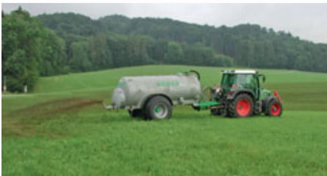
Bringt man Gülle mit dem Prallteller aus, stinkt es stärker und es geht mehr Stickstoff verloren.
